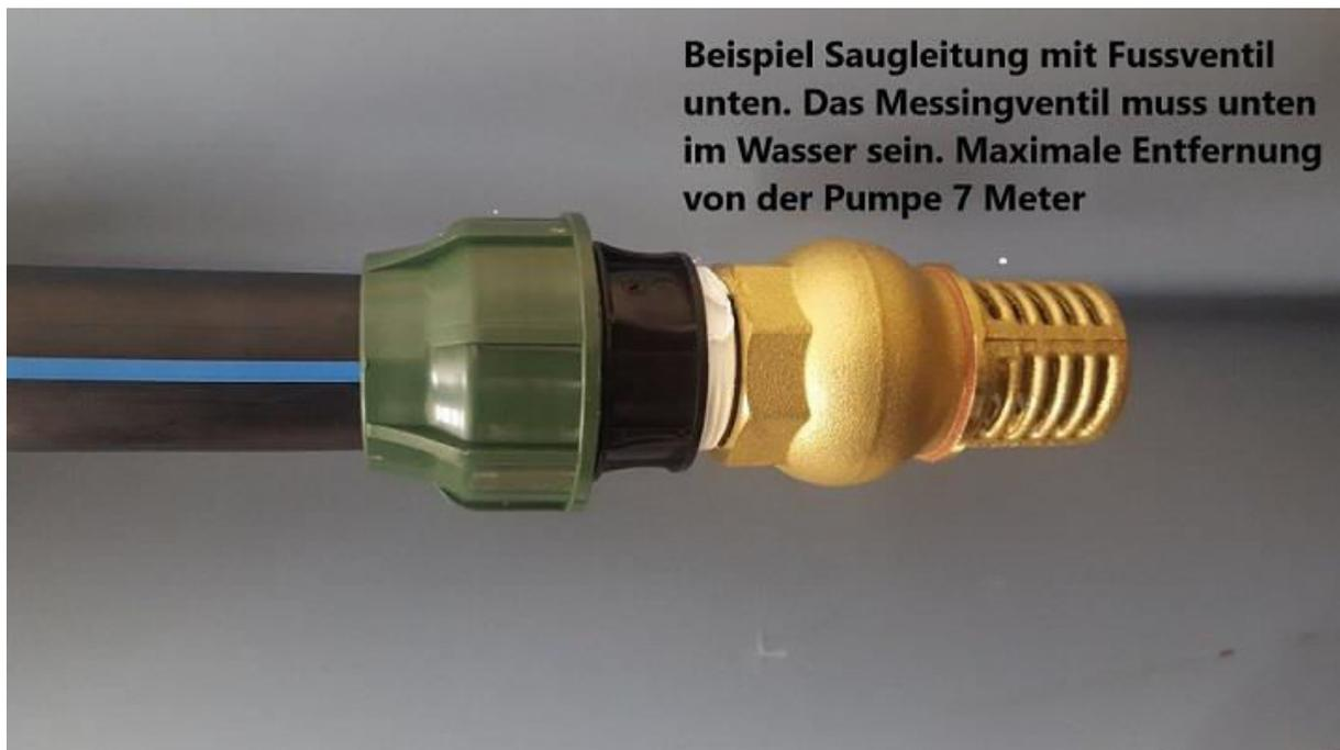
Beispiel Saugleitung mit Fussventil unten. Das Messingventil muss unten im Wasser sein. Maximale Entfernung von der Pumpe 7 Meter
